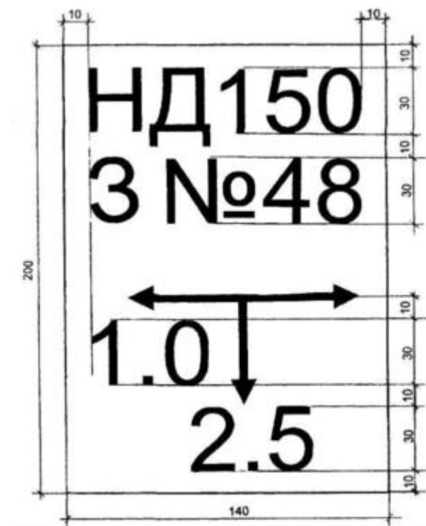
Рисунок 2. Газопровод низкого давления, диаметр – 150 мм, задвижка – № 48.
