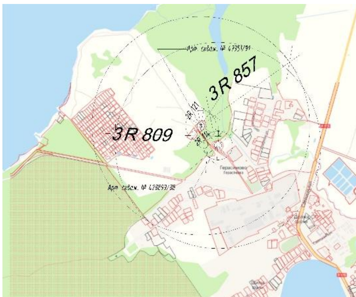
Рисунок 4.12 — Границы поясов ЗСО артезианских скважин № 42899/88, 47951/91 (первый пояс ЗСО скважин 30 м.)
