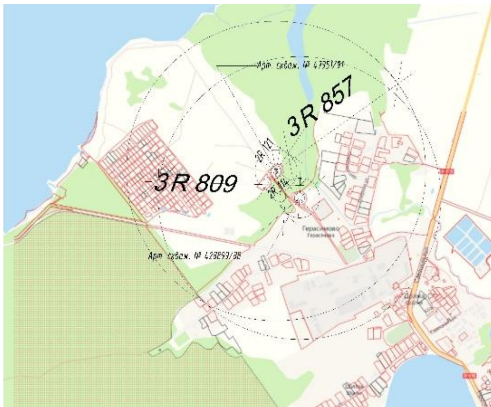
Рисунок 4.5 — Границы поясов ЗСО артезианских скважин № 42899/88, 47951/91 (первый пояс ЗСО скважин 30 м.)
